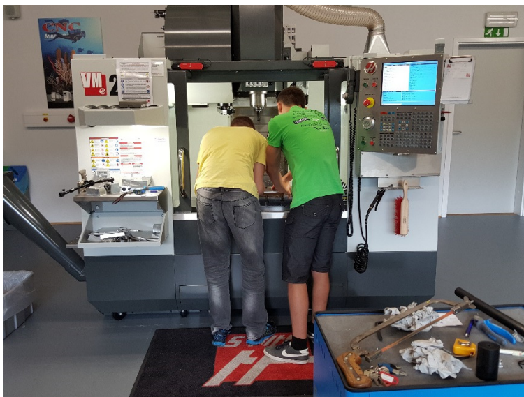
Slika 2: Izdelava ohišja tiskalnika na CNC strojih
