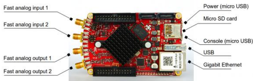
Slika 3. Merilno-računalniška kartica Red Pitaya z osnovnimi priključki.
