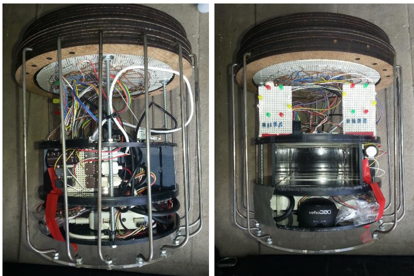
Slika 4. Sestavljeno ohišje z pripadajočo elektroniko (Šolski center Kranj)
