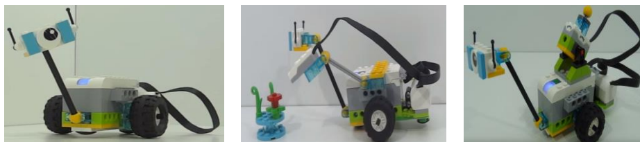
Slika 6: Raziskovalni robot, opremljen s senzorjem za gibanje in nagib
